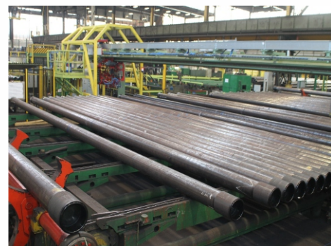
Nová linka s kapacitou 4,5 kilotony měsíčně každou trubku zváží, změří její délku, označí ji a vyrazí na ni informační údaje dle požadavku příslušné normy nebo zákazníka. Foto: Ivo Štěrba
