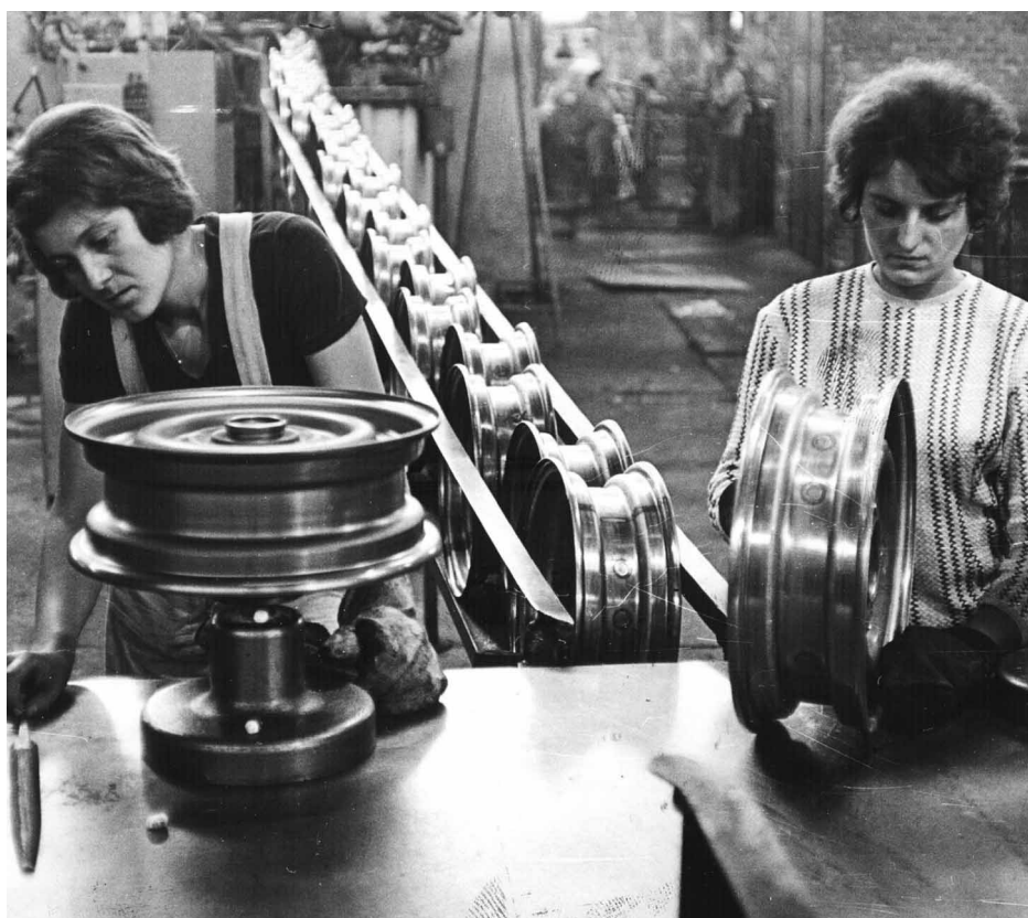
Technická kontrola osobních autokol (1967)
